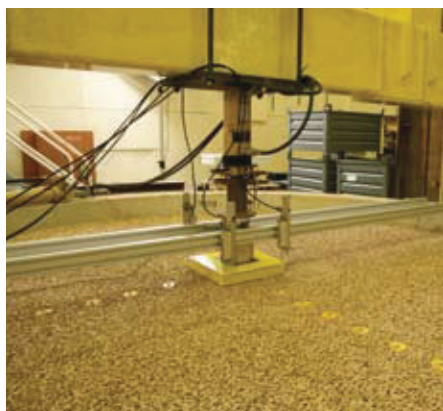
BRE 의 지지력 시험에서 TriAx 지오그리드가 하중분산을 증가시키는 것을 확인 하였습니다.
