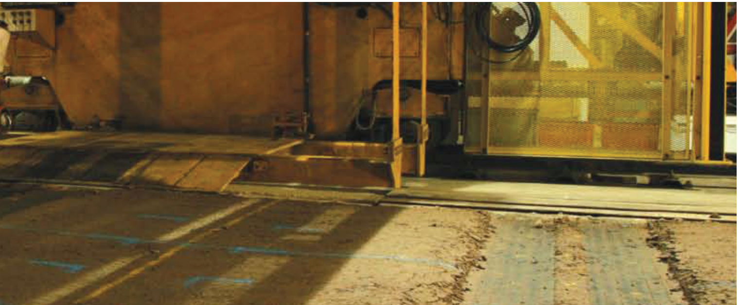
교통연구소(TRL)에 실시한 교통통행실험은 TriAx 지오그리드 성능이 이축 그리드 보다 우수하다는 것을 증명하였습니다.
